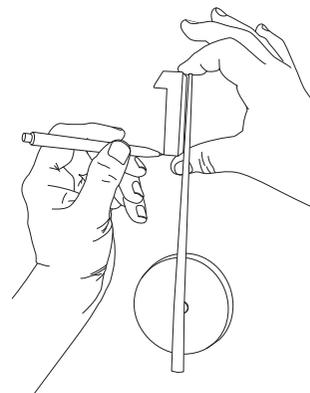
5. Ta ner urverket från väggen och tejpa upp mallen. **Obs!** Var försiktig så att inte tejpens skadar underlaget. Se till att hålet som du tidigare gjorde i mallen kommer precis över skruven och att mallen sitter i våg.
