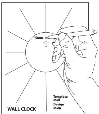
2. Bruk velegnede skruer og fest den i veggen. Forsikre deg om at det ikke er strømledninger eller vannrør i veggkonstruksjonen der du skal bore/skru. Heng deretter urverket opp på skruen.
