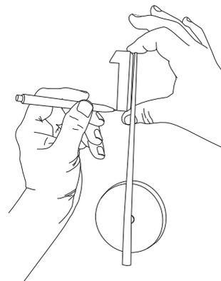
5. Ta urverket ned fra veggen og teip opp malen. **Obs!** Vær forsiktig så ikke teipen skader underlaget. Pass på at hullet du lagde tidligere i malen kommer akkurat over skruen og at malen sitter i vater.
