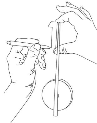
5. Das Uhrwerk von der Wand nehmen und die Schablone mit Klebeband befestigen. **Hinweis:** Vorsichtig vorgehen, sodass das Klebeband die Unterlage nicht beschädigt. Sicherstellen, dass das zuvor in die Schablone gedruckte Loch genau über der Schraube liegt und die Schablone waagrecht sitzt.
