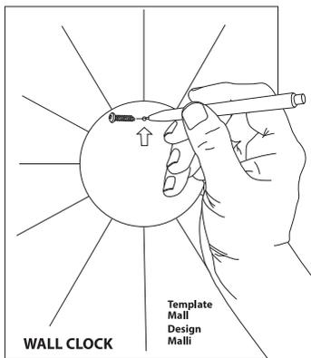
2. Eine für die Unterlage geeignete Schraube verwenden und die Schraube in der Wand festdrehen. Sicherstellen, dass sich keine Wasser- oder Stromleitungen in der Wand befinden, wo gebohrt/geschraubt wird. Das Uhrwerk an der Schraube aufhängen.
