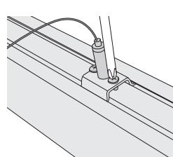
4. Asenna vajjerikiinnikkeet valaisimeen asettamalla ne ensin kotelon uriin ja työttämällä niitä sen jälkeen sivulle sopivaan kohtaan.
