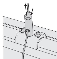
6. Gör resp. vajer kortare genom att skjuta dem genom fästet till önskad längd. De låser fast automatiskt.
