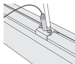
4. Montera vajerfästena på armaturen genom att först placera dem i urtaget i höljet och sedan skjuta dem åt sidan till önskad position.
