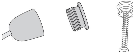
3. Ripusta valaisin kiertämällä kattokuvut kattokiinnikkeisiin.
