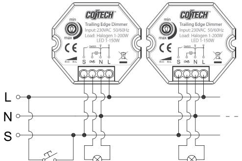
Tack vare den inbyggda synkroniseringsfunktionen kan flera (upp till 50 st.) dosdimrar styras av samma återfjädrande strömbrytare utan behov av separat synkroniseringsledning mellan dosdimrarna.
