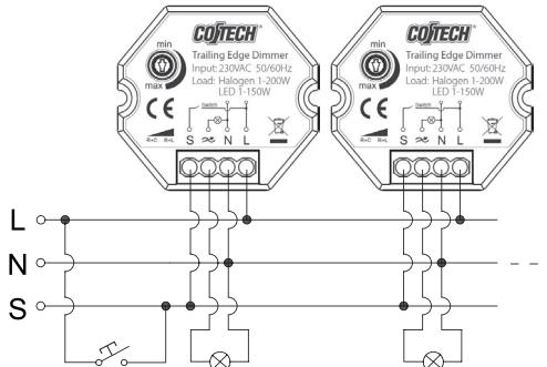
Takket være den innebygde synkroniseringsfunksjonen kan flere (opptil 50 stk.) boksdimmer styres av den samme tilbakefjærende strømbryteren uten at man trenger en separat synkroniseringsledning mellom boksdimmerne.
