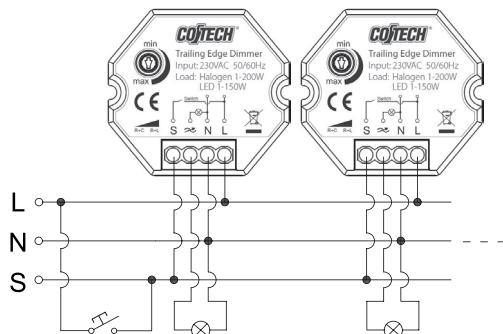
Dank der integrierten Synchronisierungsfunktion können mehrere Einbaudimmer (bis zu 50 St.) vom gleichen Taster gesteuert werden, ohne dass eine separate Synchronisierungsleitung zwischen den Einbaudimmern notwendig ist.
