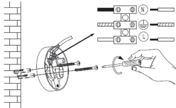
5. Das zuführende Stromkabel durch die Gummiisolierung der Wandhalterung ziehen.
