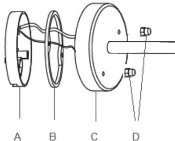
2. Løsne på de to mutterne (D) som holder lampefoten (C) fast til veggfestet (A).
