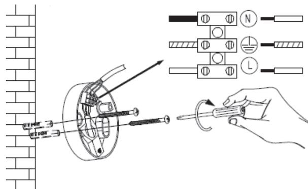
5. Dra inkommande elkabel genom gummisoleringen i väggfästet.
