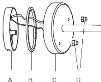
2. Lossa de två muttrarna (D) som håller fast lampfoten (C) mot väggfästet (A).
