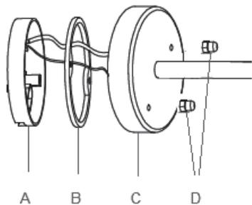
2. Die beiden Muttern (D), die den Lampenfuß (C) an der Wandhalterung (A) festhalten, lösen.
