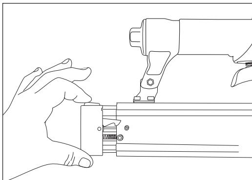
2. Das Magazin mit Stiften füllen. Überprüfen, ob die Spitzen nach unten zeigen und auf dem Boden des Magazins aufliegen.
