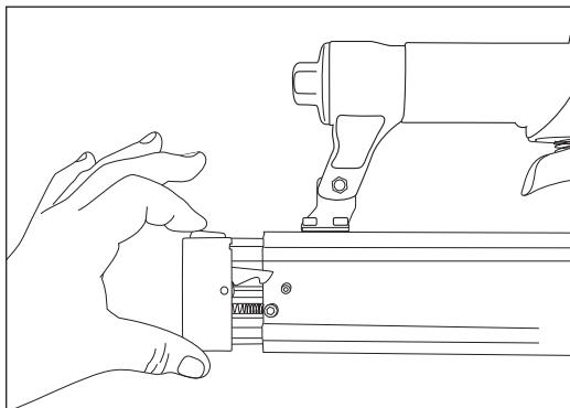
2. Laita naulat lippaaseen ja varmista, että kärjet osoittavat alaspäin ja ovat kiinni lippaan pohjassa.
