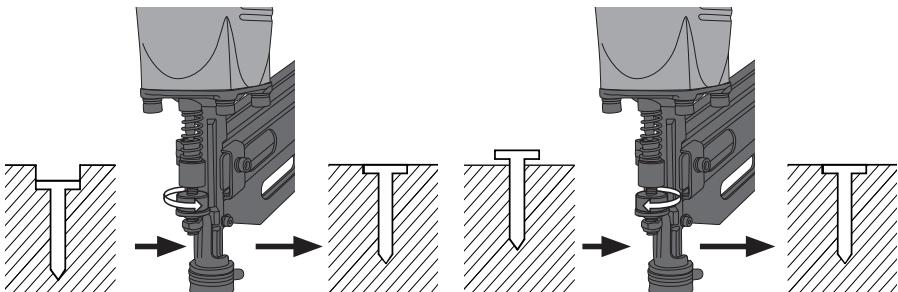
Einstellrad (2) entgegen dem Uhrzeigersinn drehen, um die Schlagtiefe zu verringern, oder im Uhrzeigersinn drehen, um die Schlagtiefe zu vergrößern.
