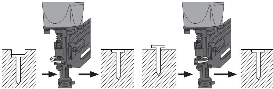
Vrid justeringsratten (2) motsols för att minska slagdjupet eller medsols för att öka slagdjupet.
