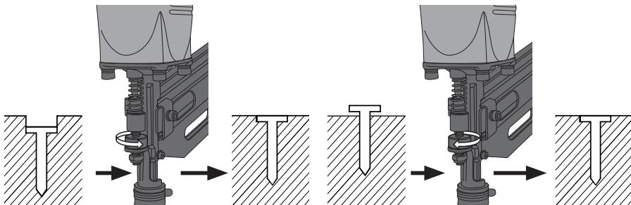
Drei rørtet med sols for å redusere slagdybden eller motsols for å øke slagdybden.
