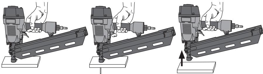
1. Hold verktøyet med et stabilt grep. Trykk verktøyet mot arbeidsoverflaten.
