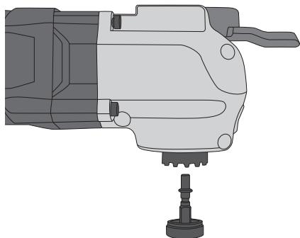
3. Die Halterung bis zum Anschlag in die Werkzeugaufnahme drücken und die Sperre wieder komplett eindrücken.
