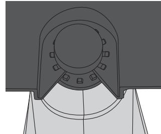
1. Vik ut spärren för verktygsfästet helt och dra ut hållaren tillräckligt mycket för att tillbehöret ska gå att sätta fast på fästet.
