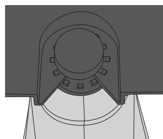
1. Die Sperre für die Werkzeugaufnahme komplett ausklappen und die Halterung soweit herausziehen, dass das Zubehör auf die Aufnahme gesetzt werden kann.
