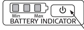
Bei vollständig geladenem Akku (100 %) leuchten alle drei LEDs. Bei einem Ladestatus von ca. 80 % leuchten zwei LEDs. Bei einem Ladestatus von ca. 25 % leuchtet nur eine LED. Leuchtet keine LED ist der Akku leer und muss geladen werden.
