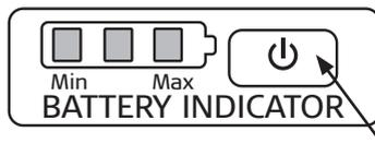
Når batteriet er 100 % fulladet lyser alle tre diodene. Ved ca. 90 % kapasitet igjen slukkes én av diodene og de to andre lyser. Når det er 25 % igjen slukker en diode til og det er kun én som lyser. Hvis ingen av diodene lyser er batteriet helt utladet og må lades.
