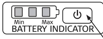
Vid fulladdat batteri (100 %) lyser alla tre dioderna. Vid ca 90 % kvar släcks en och två dioder lyser. Vid ca 25 % kvar släcks ytterligare en och endast en diod lyser. Lyser ingen diod är batteriet helt urladdat och måste laddas.
