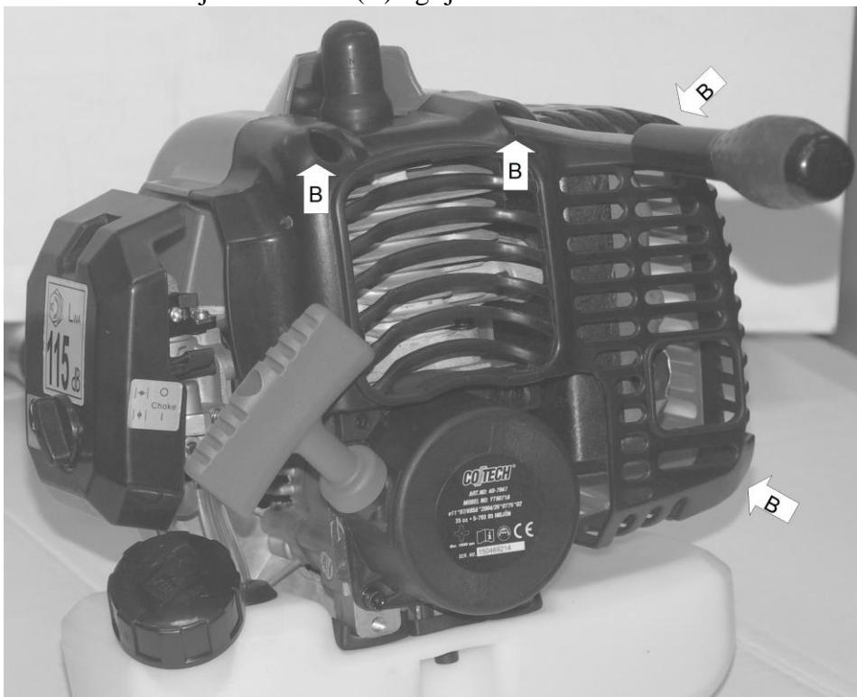
3. Skru ut de 4 skruene (C) og fjern motoren (4 mm inseksnøkkel).
