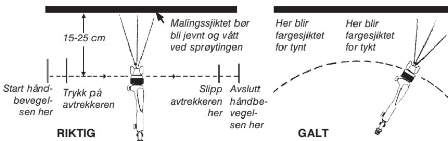
Avstanden mellom pistolmunnstykket og arbeidsstykke bør være mellom 15 og 25 cm, avhengig av malingstype og luftrykk. Det påsprutede sjiktet bør bli jevnt og vått ("glinsende"). Sprøyt med litt overdekking av foregående omgang, for å få en helt jevn finish.
