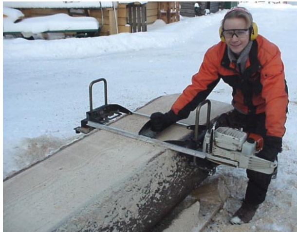
LSG utan linjaler. Stockens plana yta styr nästa skär.
