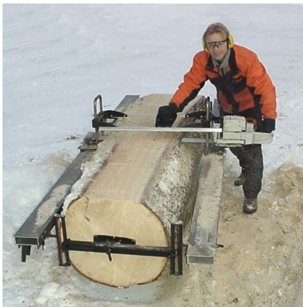
LSG med dubbla linjaler, arm EXT och fästplatta EXT.
