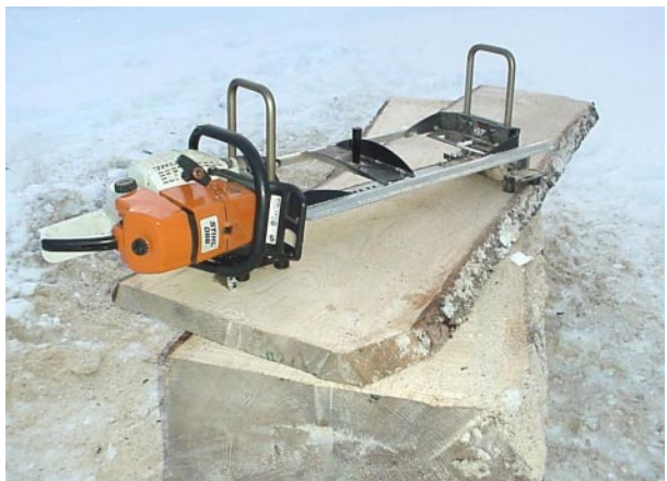
LSG utan linjaler. Stockens plana yta styr nästa skär.
