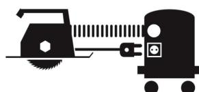
Torr- och våtsugarens till- och fränslag kommer att styras automatiskt av den anslutna maskinen. Tillslag av torr- och våtsugaren sker ca 3 sekunder efter det att den anslutna maskinen har startats, och stängs av efter ca 10 sekunder efter att den anslutna maskinen har stängts av.
