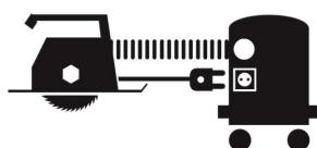
Tørr- og våtsugeren vil nå bli styrt av når den andre maskinen (f. eks. sagen) startes og stoppes. Tilslag av tørr- og våtsugeren skjer ca 3 sekunder etter at den tilkoblede maskinen startes, og skrus av ca 10 sekunder etter at den tilkoblede maskinen skrus av.
