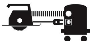
Liitetty laite ohjaa automaattisesti kuiva-/märkäimurin imu- ja puhallusliitääntöjä. Kuiva-/märkäimuri käynnistyy noin kolmen sekunnin kuluttua liitetyn laitteen käynnistämisestä ja sammuu noin 10 sekunnin kuluttua liitetyn laitteen sammuttamisen jälkeen.
