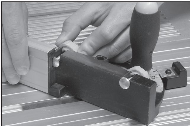
Geringsanhållet kan skjutas in i ett av dom två spåren på släden och låsas genom att dra åt geringsanhållets handtag.
