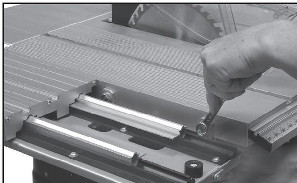
Skift ut aluminiumsskinen på bordsirkelsagens gjæringsanhold med den lange aluminiumsskinen som følger med i denne forpakningen.
