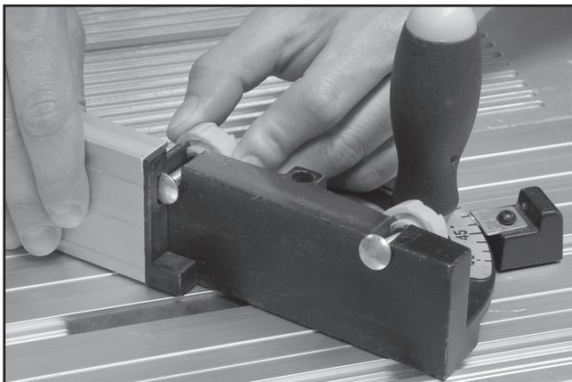
Gjæringsanholdet kan skyves inn i ett av de to sporene på sleden og låses ved å dra til håndtaket på gjæringsanholdet.
