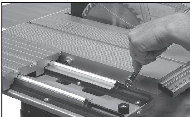
Byt ut aluminiumskenan på bordcirkelsågens geringsanhåll mot den längre aluminiumskenan som medföljer i förpackningen.
