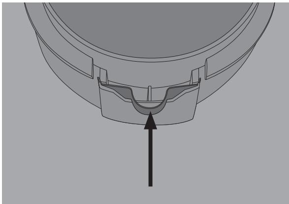
2. Lägg ut låskragnen på så sätt som den ska monteras dvs. snäppålåset ska vara på höger sida.
