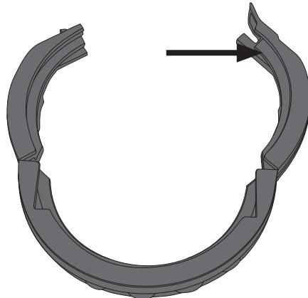
3. Placera utkastet på plats med öppningen rakt fram och håll fast det.
