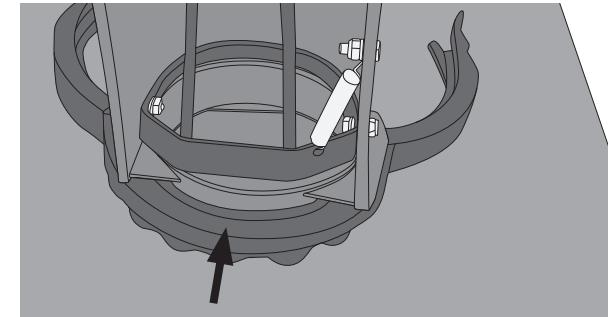
6. Fäst ihop låskragnen, se till att snäplåsen låser. Vrid utkastet åt sidan så blir det lättare att komma åt snäplåsen.
