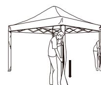
4. Håll i ett av stativets ben med en hand och dra benet uppåt tills kulspärren låser fast. Gör likadant med alla ben.
