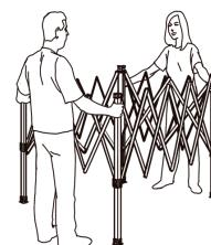
2. Vorsichtig den Rahmen des Dachs nach oben ziehen, bis die Sperre einrastet. Aufpassen, dass keine Finger eingeklemmt werden.
