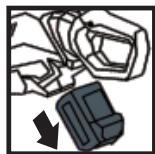
Poista akku, ennen kuin säädät tai puhdistat laitetta, tai enne kuin jätät laitteen ilman valvontaa.
