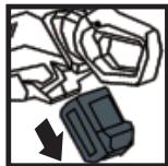
Ta ut batteriet før du utfører en innstilling eller rengjør maskinen eller hvis maskinen står uten oppsyn over lengre tid.
