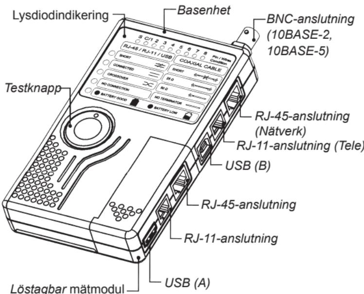
**Varning!** Anslut aldrig nätverkstestaren till ett nät som används och är aktivt, lossa kablarna innan testning!
