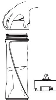
3. Danach das Gefäß umdrehen und im Uhrzeigersinn an der Motoreinheit festdrehen.
