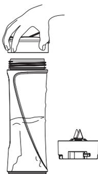
4. Tryck och håll in knappen för att starta, när du släpper knappen stannar blendern. När du är klar, ta bort flaskan och vänd tillbaka den till upprätt läge, skruva bort skärbladet och sätt på det spillsäkra locket på flaskan.
