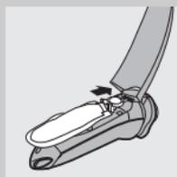
**3** Skjut in patronen med pump i rakapparaten. Den passar bara om pumpens vita sida är vänd uppåt.
