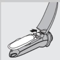
**4** Skjut in patronen med pump i rakapparaten. Den passar bara om pumpens vita sida är vänd uppåt. Stäng luckan.
