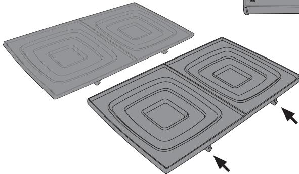
4. Tilpass så de fremste låsetappene mot låsene på smørbrødgrillens fremre del, og trykk deretter forsiktig ned innlegget til det låses ordentlig.
