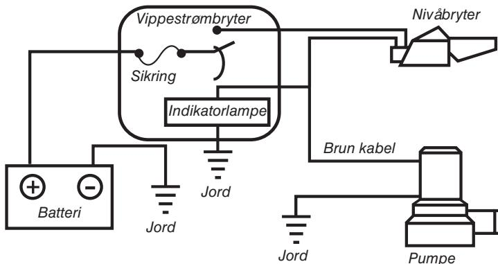
Pumpen slås på/av automatisk når vannnivået stiger/synker. Pumpen kan også aktiveres manuelt med f.eks. en fjærende vippestrømsbryter på panelet.
