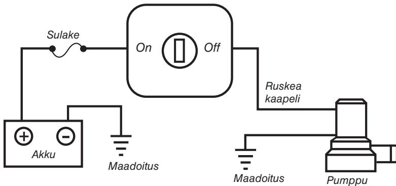
Pumppu tulee käynnistää ja sammuttaa manuaalisesti virtakytkimellä.
