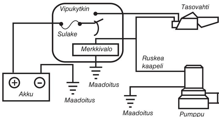
Pumppu käynnistyy ja sammuu automaattisesti veden tason nostessa ja laskiessa. Pumppu voidaan aktivoida myös manuaalisesti esim. paneeliin asennettavalla palauttavalla vipukytkimellä.
