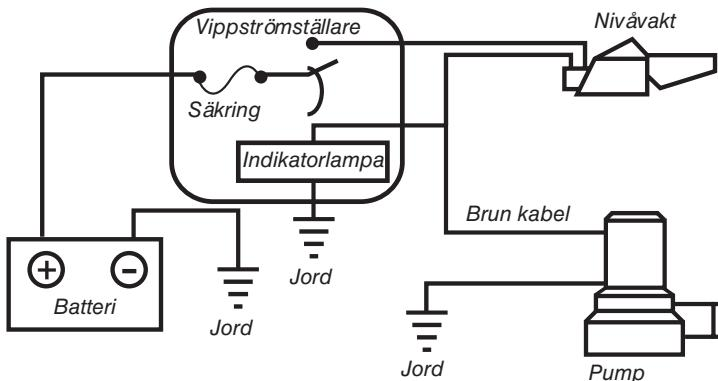
Pumpen slås på och av automatiskt när vattennivån stiger eller sjunker. Pumpen kan även aktiveras manuellt med t.ex. en återfjädrande vippströmbrytare på panelen.
