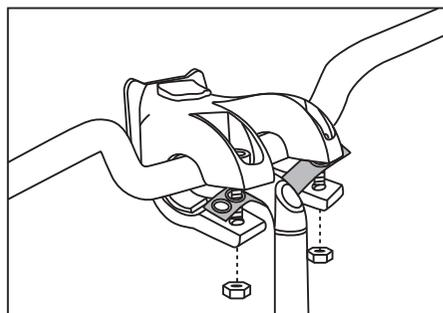
**Steg 4.** För att fästa väskan på styret, passa in väskans fästplatta i hållaren och skjut väskan tills du hör ett klickljud.
