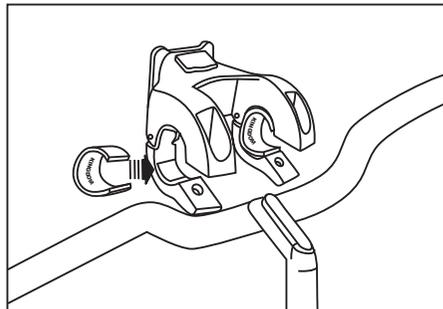
**Kohta 2.** Laita ruuvit ja aluslaatat puristimen yläpuolella oleviin reikiin.
