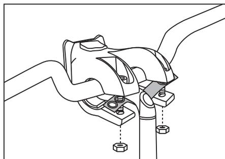
**Kohta 4.** Kun kiinnität laukkuja ohjaustankoon, aseta laukun kiinnityslevy kiinnikkeeseen ja työnnä laukkuja, kunnes se napsahtaa paikoilleen.
