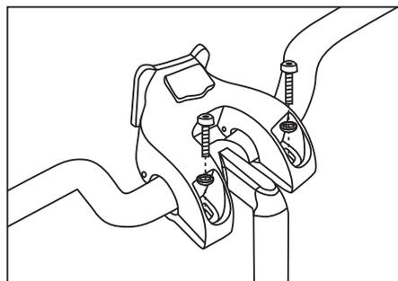
**Kohta 3.** Aseta remmi siten, että ruuvit osuvat reikiin. Kierrä mutterit kiinni. Varmista, että kiinnike on kunnolla kiinnitetty ennen käyttöönottoa.
