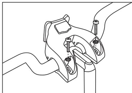
**Steg 3.** Placera remmen så att skruvarna passar i hålen och skruva åt muttrarna. Se till att hållaren är ordentligt festsatt innan användning.
