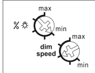
**Min. ljusstyrkan kan ställas in med %.****Dimningshastigheten kan ställas in med dim. speed**, detta ställer samtidigt in hastigheten för mjuk PÅ och mjuk AV.
