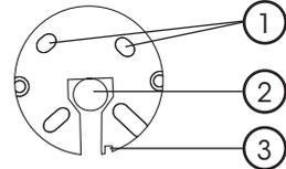
5. För igenom inkommande ledare genom centrumhålet (2) och skruva fast plastdosan mot väggen. Notera att plastdosan måste sitta med dräneringshålet (3) nedåt.
