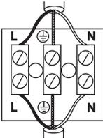
*Blau (Neutraleiter) wird an den Eingang der Lüsterklemme mit Kennzeichnung „N“ angeschlossen.*
