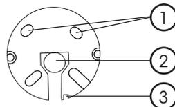
5. Før ledningen gjennom sentrumshullet (2) og skru boksen fast på veggen. Merk deg at boksen må sitte med dreneringshullet (3) vendt nedover.
