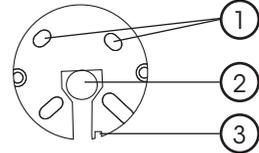
5. Die Stromzufuhr durch das Loch in der Mitte (2) führen und die Kunststoffdose an der Wand festschrauben. Darauf achten, dass die Kunststoffdose mit der Drainageöffnung (3) nach unten montiert wird.
