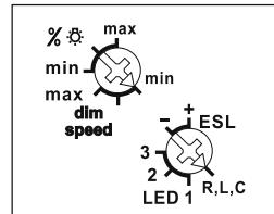
Med den övre %-inställningsratten resp dim-speed-inställningsratten kan lägsta ljusstyrka (max ned dimrat) och dimmingshastigheten ställas in.
