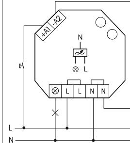
Manöverspänning, driftspänning och brytspänning 230V
