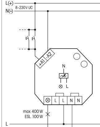
Manöverspänning 8-230V AC/DC, driftspänning och brytspänning 230V
