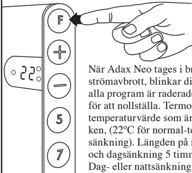
När Adax Neo tages i bruk, eller efter ett längre strömavbrott, blinkar displayen för att visa att alla program är raderade. Tryck på knappen "F" för att nollställa. Termostaten får automatiskt de temperaturvärde som är grundinställt från fabriken, (22°C för normal-temperatur och 15°C vid sänkning). Längden på nattsänkning är 7 timmar och dagsänkning 5 timmar. Dag- eller nattsänkning är inte aktiverad.
