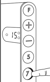
På den tidpunkt som sänkningen skall börja, tryck "7" tills 15°C visas i displayen. Nu blinkar grön lampa (B) sakta som tecken på att sänkningen är aktiv. Temperaturen sänker sig till 15°C de kommande 7 timmarna. Nattsänkning startar nu på samma tidpunkt varje kväll.
