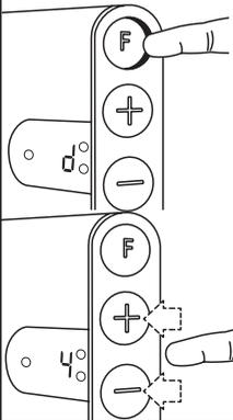
Auf "F" drücken, bis das Display "d" (day = Tag) anzeigt. Dann auf  $\Delta$  oder  $\nabla$  drücken, bis das Display die Zahl des gewünschten Tages anzeigt. Montag = 1, Dienstag = 2 usw. Durch Druck auf "F" die Einstellung beenden, ansonsten wird nach ca. 30 Sekunden die Einstellung automatisch gespeichert und beendet.
