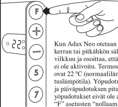
Kun Adax Neo otetaan käyttöön ensimmäisen kerran tai pitkähkön sähkökatkon jälkeen, näyttö vilkkuu ja osoittaa, että mitään pudotusohjelmaa ei ole aktivoitu. Termostaatin tehdasasetukset ovat 22 °C (normaalilämpötila) ja 15 °C (pudotuslämpötila). Yöpudotuksen pituus on 7 tuntia ja päiväpudotuksen pituus on 5 tuntia. Päivä- ja yöpudotukset eivät ole aktiivisia. Paina näppäintä "F" asetusten "nollaamiseksi".
