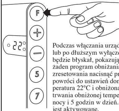
Podczas włączania urządzenia Adax Neo do pracy lub po dłuższym wyłączeniu zasilania, wyświetlacz będzie błyskał, pokazując, że nie jest aktywny żaden program obniżania temperatury. W celu zresetowania nacisnąć przycisk „F”, urządzenie DT powróci do ustawień domyślnych: komfortowa temperatura 22°C i obniżona temperatura 15°C. Czas trwania obniżonej temperatury wynosi 7 godzin w nocy i 5 godzin w dzień. Obniżanie temperatury nie jest aktywowane.
