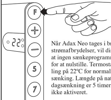
Når Adax Neo tages i brug, eller efter længere strømafbrydelser, vil displayet blinke som tegn på at ingen sænkeprogrammer er aktive. Tryk på "F" for at nulstille. Termostaten har fabriks-indstilling på 22°C for normaltemperatur og 15°C for sænkning. Længde på natsænking er 7 timer og dagsænking er 5 timer. Dag- eller natsænking er ikke aktiveret.
