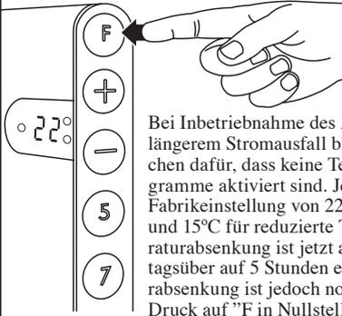
Bei Inbetriebnahme des Adax Neo oder nach längerem Stromausfall blinkt das Display als Zeichen dafür, dass keine Temperaturreduktionsprogramme aktiviert sind. Jetzt hat der Thermostat die Fabrikeinstellung von 22°C für Normaltemperatur und 15°C für reduzierte Temperatur. Die Temperaturabsenkung ist jetzt auf nachts 7 Stunden und tagsüber auf 5 Stunden eingestellt. Die Temperaturabsenkung ist jedoch noch nicht aktiviert. Durch Druck auf "F" in Nullstellung bringen
