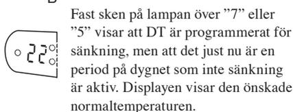
**B** Fast sken på lampan över "7" eller "5" visar att DT är programmerat för sänkning, men att det just nu är en period på dygnet som inte sänkning är aktiv. Displayen visar den önskade normaltemperaturen.
