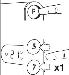
Bei gedrücktem "F" einmal auf "7" oder "5" drücken, um die aktive Periode oder die nächste Absenkungsperiode aufzuheben. Während der aktuellen Periode leuchtet die entsprechende Lampe A oder B konstant. Ab der folgenden Periode wird die Absenkung wieder aktiviert.
