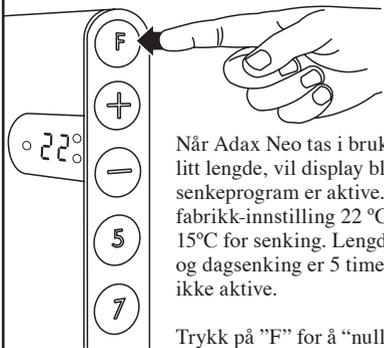
Når Adax Neo tas i bruk, eller etter strømbrudd av litt lengde, vil display blinke som tegn på at ingen senkeprogram er aktive. Termostaten vil nå ha fabrikk-innstilling 22 °C for normaltemperatur og 15°C for senking. Lengde på nattsenkning er 7 timer og dagsenkning er 5 timer. Dag- eller nattsenkning er ikke aktive.
