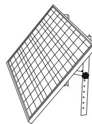
2. Montera solpanelen på tak eller vägg och ställ in lämplig vinkel genom att flytta de medföljande stagen mellan hålen i stativet.
