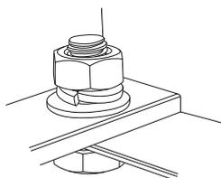
1. Monter stativet i rammet til solpanelet. Bruk medfølgende bolter, skiver og mutre.
