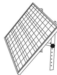
2. Monter solpanelet på tak eller vegg og still det inn i en passende vinkel ved å flytte de medfølgende stagene mellom hullene i stativet.
