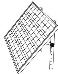
1. Stativ am Rahmen des Solarmoduls montieren. Die mitgelieferten Schrauben, Platten und Muttern verwenden.
