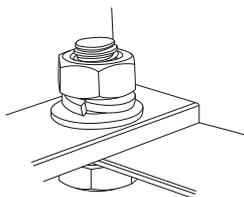
1. Montera stativet i solpanelens ram. Använd medföljande bultar, brickor och muttrar.
