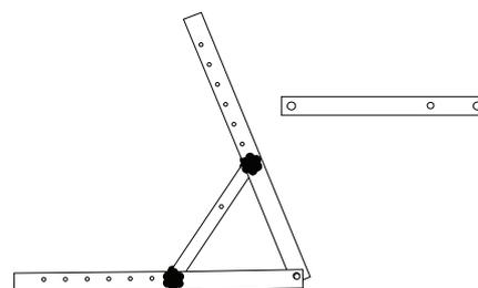
Die lange Stütze bei Dachmontage verwenden, um einen Winkel zwischen 30–70° zu erreichen.
