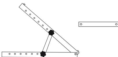
Die kurze Stütze (230 mm) bei Wandmontage verwenden, um einen Winkel zwischen 15–40° zu erreichen.
