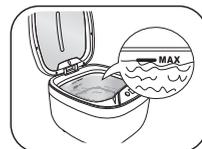
4. Steng lokket og plugg støpselet i strømuttaket. «180» vises på skjermen. Det er den forhåndsinnstilte tiden på rengjøringen. Trykk [On/off] for å slå på ultralydvaskeren, eller trykk på [Set] for å velge en annen timerinnstilling og deretter [On/off] for å slå på vaskeren.
