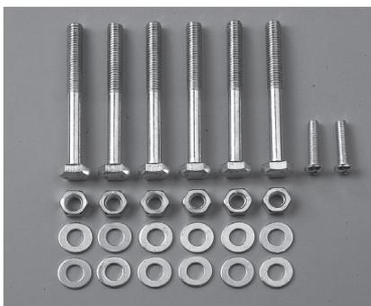
Medföljande skruvar, muttrar och brickor som behövs för ihopmontering av väggfästets justerbara armar.
