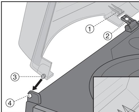
3. Sett først lokkets venstre pigg [3] i platespillerens venstre knott [4] og trykk deretter forsiktig fast lokkets høyre knott [5] på platespillerens høyre feste [6].
