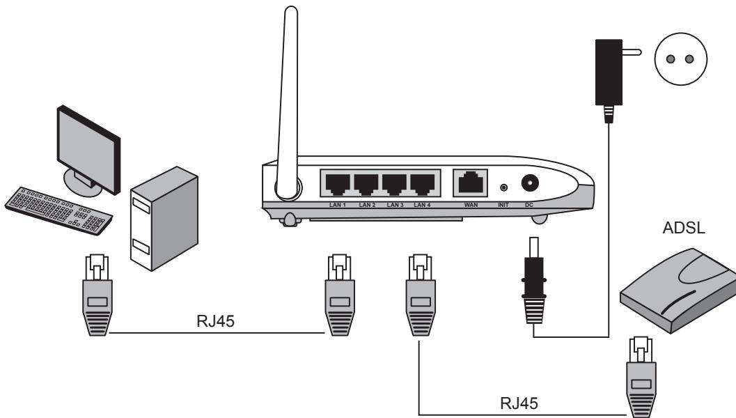
Använd endast TP-kablar av "rak" typ.
