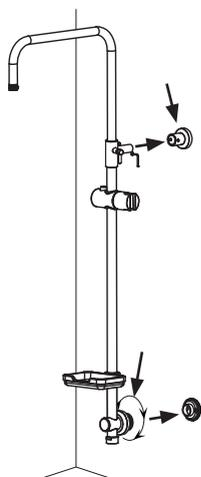
10. Montera stängan på det övre väggfästet och dra åt låsskruvarna. Skruva fast det nedre väggfästet på fästplattan.
