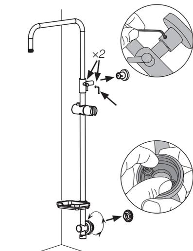
7. Skru løs det øvre veggfestet 2 låseskruer med medfølgende inseksnøkkel, og ta veggfestet bort fra stangen.
