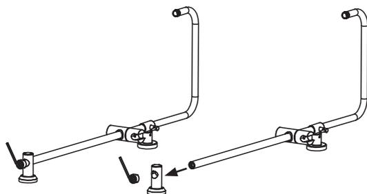
2. Använd den medföljande insexnyckeln och skruva ur fästhylsan i botten på duschstången. Be någon hålla stången medan du skruvar så går det lättare. Ta bort fästhylsan och den lekande muttern.
