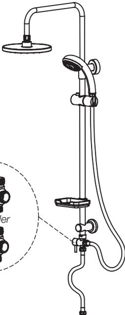
14. Den Schlauch vom Umschalter an die Armatur anschließen. Eine Gummidichtung anbringen.
