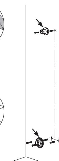
9. Ruuvaa seinäkiinnike ja kiinnityslevy seinään.
