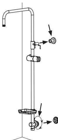
10. Die Stange an der oberen Wandhalterung anbringen und die Feststellschrauben anziehen. Die untere Wandhalterung auf der Montageplatte festschrauben.
