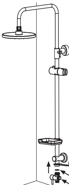
13. Montera tillbaka omkopplaren i botten på duschstången, använd en gummitätning.
