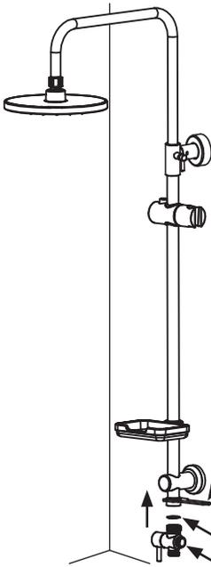
13. Den Umschalter wieder an die Unterseite der Stange anbringen, dabei eine Gummidichtung verwenden.
