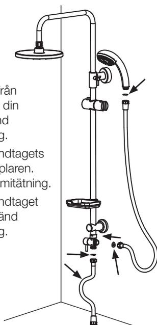
14. Anslut slangen från omkopplaren till din blandare. Använd en gummitätning.
