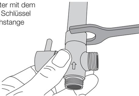
2. Den mitgelieferten Innensechskantschlüssel benutzen um die Befestigungshülse an der Unterseite der Duschstange loszuschrauben. Dies geht einfacher wenn eine andere Person die Stange festhält. Die Befestigungshülse und die Überwurfmutter abnehmen.
