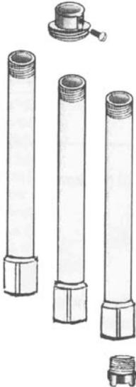
Kiinnitä seuraava imuputkiosuus toiseen päähän. Jatka kunnes kaikki osat on asennettu. 3 kpl, 28 cm pitkiä imuputkia sisältyy toimitukseen. Kiinnitä adapteri (del nr. 6) kärkiosaan imuputken päälle kierteitetty osa alaspäin.
