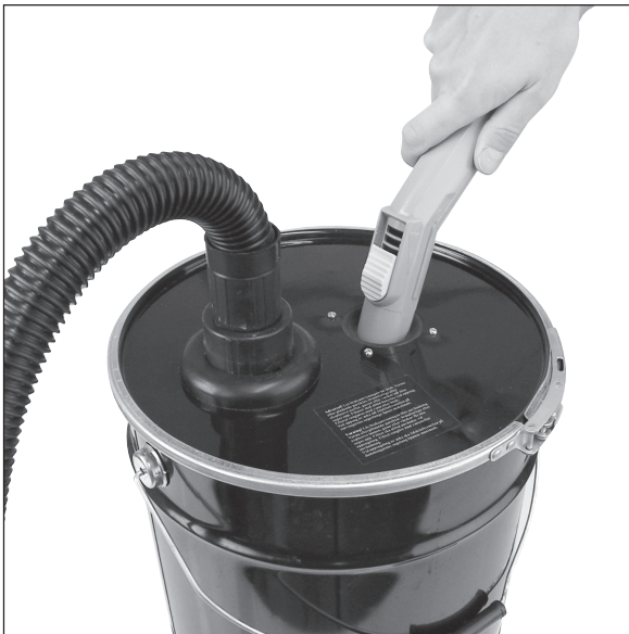
Työnnä pölynimurin letkukahva kannen kumitiiviteen läpi. Tuhkan imemisessä pölynimurin letkun ilmansäädin on avattava maksimiasentoon.
