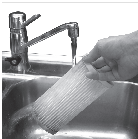
Veckfiltret rengörs enklast genom att det sköljs av i rinnande vatten. Ett rengjort filter ökar sugeffekten.
