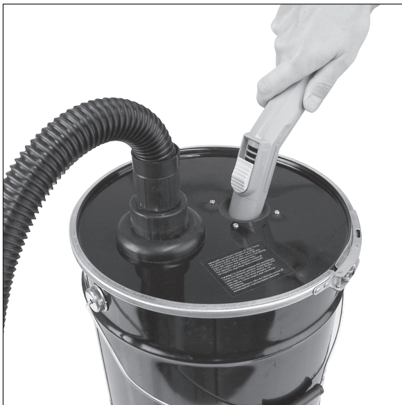
Støvsugerens slangehåndtak stikkes gjennom gummipakningen på lokket. Ved oppsuging av aske må luftventilen på støvsugerens håndtak åpnes maksimalt.
