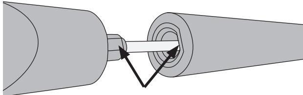
2. Työnnä lämpömittari takaisin taikinakaapimeen (se sopii vain yhdellä tavalla). Lämpömittarin etupuolen kiinnitin sopii taikinakaapimen kantaan.
