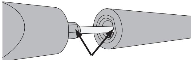
2. Skjut tillbaka termometern i slickepotten, den passar bara på ett sätt, termometerns fasade fäste passar mot klacken i slickepotten.
