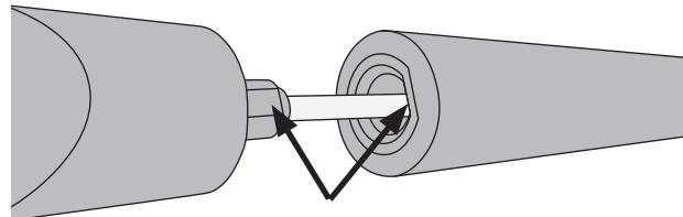
2. Das Thermometer zurück in den Teigspatel drücken, dies geht nur auf eine Weise, da der abgeschrägte Schaft des Thermometers genau an den Zapfen am Teigspatel passt.
