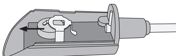
4. Skyv forsiktig et nytt batteri inn i holderen. Batteritype SR44. Pass på at plussmarkeringen (+) på batteriet vender oppover mot deg.
