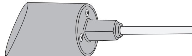
1. Skruva ur de två skruvarna som håller locket över batterihållaren.
