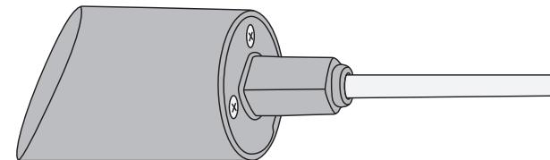
1. Die beiden Schrauben, die die Abdeckung über dem Batteriefach festhalten, herausdrehen.
