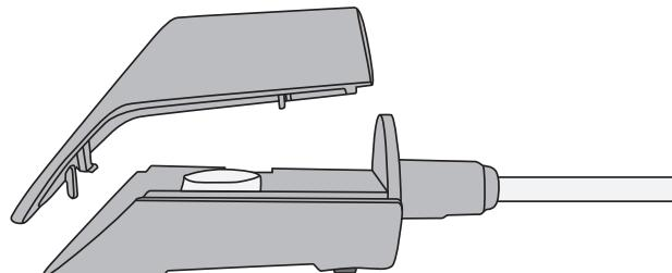
3. Skyv batteriet forsiktig ut av holderen med en passende gjenstand.
