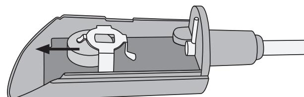
3. Skjut försiktigt ut batteriet ur hållaren med lämpligt föremål.
