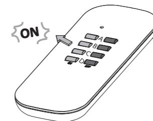
5. Trykk en gang på en av knappene (A, B, C eller D) på fjernkontrollen. Lysdioden på mottakeren går over til å lyse når fjernkontrollen er koblet til.
