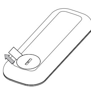
1. Trekk plastfliken bort fra fjernkontrollen for å aktivere batteriet.
