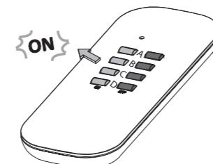
5. Tryck en gång på en av fjärrkontrollens på-knappar (A, B, C eller D). Lysdioden på mottagaren övergår till fast sken när fjärrkontrollen anslutits.
