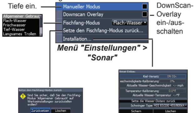
Wenn Sie den manuellen Modus des Gerätes verwenden, empfangen Sie möglicherweise keine Tiefenmessungen, oder Sie empfangen falsche Tiefeninformationen.
