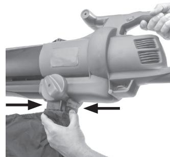
Überprüfen, ob das Saug-/Blasrohr oder das Gebläse mit Laub blockiert sind, falls die Saugleistung abnimmt, obwohl der Sack nicht voll ist. Das Saug-/Blasrohr bzw. das Gebläse folgendermaßen reinigen:
