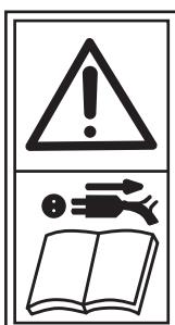
Irrota aina sähköjohdon pistoke pistorasiasta ennen laitteen puhdistusta tai säättöä.
