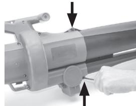
3. Montera lövsäcken på motorhuset: Tryck lövsäckens öppning mot anslutningen på motorhuset tills lövsäckens båda snäplås låser fast den. Se till att lövsäcken sitter fast ordentligt innan du startar lövsugen/lövblåsen.
