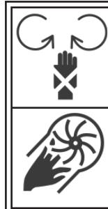
**Varning!** Risk för att fastna i inmatningsöppningen. Håll undan händer och fötter från lövsugens/lövblåsens öppningar när den är i drift.
