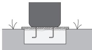
5. Mit einer Wasserwaage sicherstellen, dass der Briefkasten so gerade wie möglich steht. Mit den Muttern an den Befestigungsbolzen kann dies später genauer eingestellt werden.
