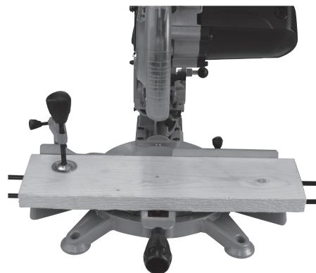
**Advarsel!** Maskinens balansefjær trykker sagehodet auto-matisk opp etter kappingen. Slipp derfor ikke håndtaket når kappingen er ferdig. Hold i håndtaket og brems forsiktig når sagehodet fjører opp.
