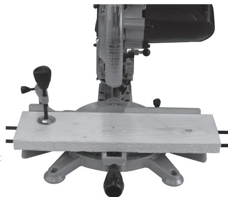
**Varning!** Maskinens balansfjädrar trycker automatiskt upp såghuvudet efter kapningen. Släpp därför inte handtaget när kapningen är klar, håll i handtaget och bromsa svagt när såghuvudet fjädrar upp.
