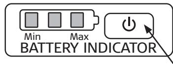
Når batteriet er 100 % fulladet lyser alle tre diodene. Ved ca. 90 % kapasitet igjen slukkes én av diodene og de to andre lyser. Når det er 25 % igjen slukker en diode til og det er kun én som lyser. Hvis ingen av diodene lyser er batteriet helt utladet og må lades.
