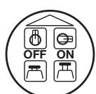
Zum Abschalten des Kompressors niemals den Stecker ziehen oder einen eventuell vorhandenen Hauptschalter ausschalten. Dafür ist immer der ON/OFF-Schalter am Kompressor zu verwenden.
