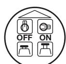
Älä sammuta kompressoria päävirtakytkimestä tai irrottamalla pistoke pistorasiasta. Sammuta kompressoril aina ON/OFF-painikkeella.
