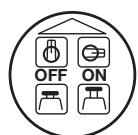
Trekk aldri ut stopselet eller skru av ev. hovedstrømbryter for å stenge kompressoren. Bruk alltid kompressorens ON/OFF-knapp.
