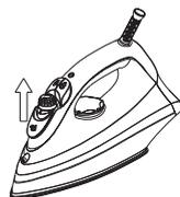
8. Trekk ut støpselet og still inn dampbryteren på **0** til det vannet slutter å strømme ut.
