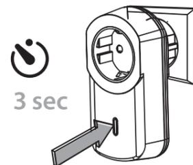
3. Die Aus-Taste an der Fernbedienung drücken (dabei auf die richtige Aus-Taste drücken, wenn die Fernbedienung weitere Empfänger ansteuert). Die Fernbedienung wird vom Empfänger gelöscht.
