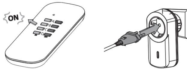
5. Einmal auf eine der Ein-Tasten an der Fernbedienung drücken (A, B, C oder D). Die LED am Empfänger leuchtet konstant, wenn die Fernbedienung mit ihr verbunden ist.
