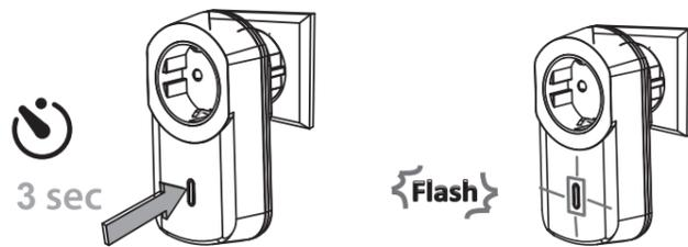
3. Die Taste auf der Vorderseite des Empfängers 3 Sekunden lang gedrückt halten und dann loslassen.
