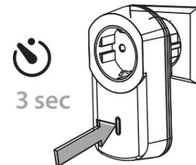
2. LED-indikatorn i knappen börjar blinka långsamt. Mottagaren är nu redo att radera fjärrkontrollen.
