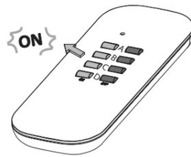
5. Trykk en gang på en av knappene (A, B, C eller D) på fjernkontrollen. Lysdioden på mottakeren går over til å lyse når fjernkontrollen er koblet til.
