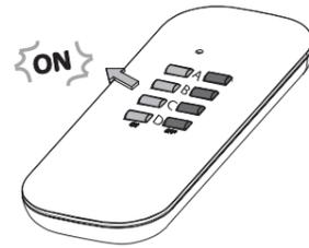
5. Tryck en gång på en av fjärrkontrollens på-knappar (A, B, C eller D). Lysdioden på mottagaren övergår till fast sken när fjärrkontrollen anslutits.
