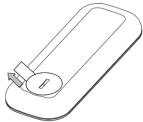
1. Trekk plastfliken bort fra fjernkontrollen for å aktivere batteriet.
