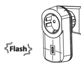
4. LED-indikatorn i knappen börjar blinka långsamt. Mottagaren är nu i inlärningsläge och redo att kopplas samman med fjärrkontrollen.
