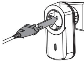
6. En passende lampe kobles til mottakeren. Du må forsikre deg om at belysningen er skrudd på.
