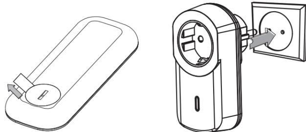
1. Zum Aktivieren der Batterie den Kunststoffstreifen von der Fernbedienung entfernen.
