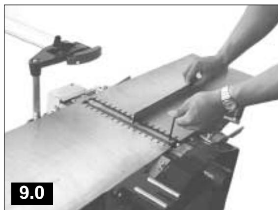
Juster utsticket med medföljande 3 mm insektnyckel genom att vrida kilens tre ställskruvar ut och in efter önskan. Efter korrekt inställning drar du åt sexkantskruvorna igen. **Börja med skruven i mitten.**
