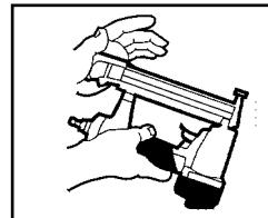
3. Tryck in klammermagasinet tills spärren snäpper in i läge.
