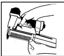
2. Håll magasinet helt öppet. Sätt in spikarna. Spetsarna måste ta stopp mot bottnen på magasinet.
