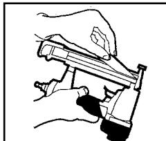
2. Lägg in klammerstavar i magasinet.
