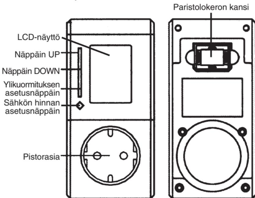
PM - 300 mittaa sähkölaitteen kuluttaman sähköisen energian. Sähkökulutusmittarilla voit laskea sähkölaitteen kokonaiskustannuksen ilmoittamalla sähkon kilowattituntihinnan (kWh). Laite rekisteröi myös mahdollisen ylikuormituksen. Suosittelemme, että luet koko käyttöohjeen ennen sähkökulutusmittarin käyttöönottoa. Nämä saat parhaan hyödyn sähkökulutusmittaristasi.
