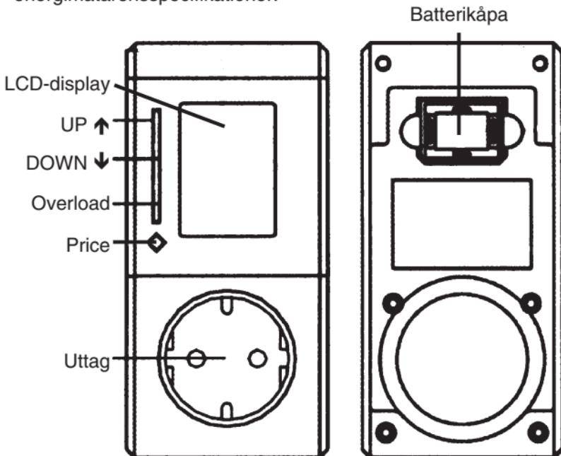
PM - 300 är ett instrument som mäter den elektriska energi som förbrukas av en elapparat. Instrumentet kan räkna ut den totala kostnaden för elförbrukningen, genom att du anger din eltaxa i kWh. Den kan även registrera eventuell överbelastning. För att du ska kunna använda denna energimätare på bästa möjliga sätt rekommenderar vi att du läser igenom hela manualen innan du börjar använda mätaren.
