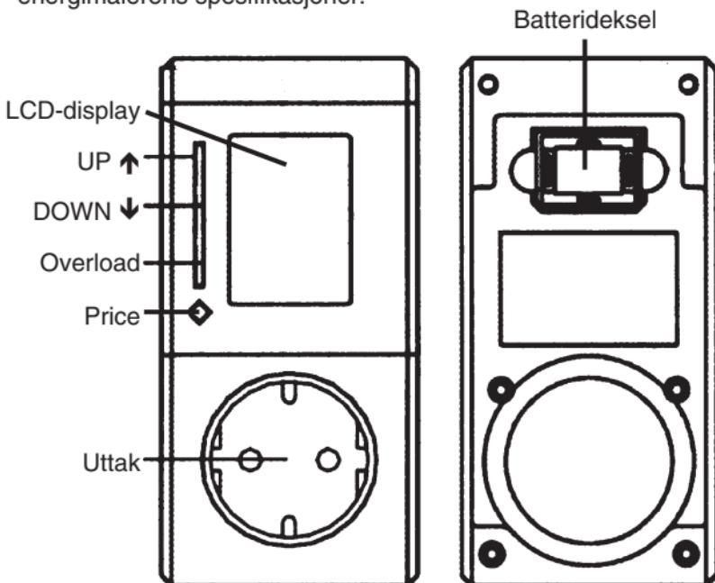
PM-300 er et instrument som måler den elektriske energien som forbrukes av et el.apparat. Instrumentet kan regne ut den totale kostnaden for strømforbruket ved at du oppgir strømprisen per kWh. Den kan også registrere ev. overbelastning. For at du skal kunne bruke denne energimåleren på best mulig måte, anbefaler vi at du leser hele bruksanvisningen før du tar strømmåleren i bruk.
