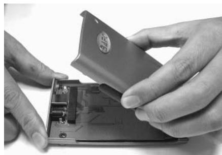
1. Lossa skruvarna på undersidan, dela häljet.
