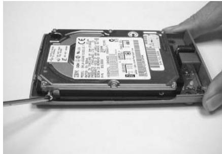
2. Montera hårddisken, anslut flatkabel (röd markering på flatkabel mot stift 1 på hårddisken) och strömkabel. Fäst hårddisken med de medföljande skruvarna.
