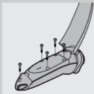
**1** La barbermaskinen gå til den stopper, skru løs skruene og åpne barbermaskinen.
