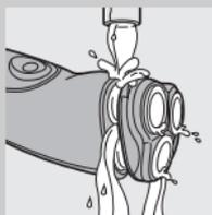
Tørk aldri skjæreenheten med et håndkle eller tørkepapir. Det kan skade skjærehodene.
