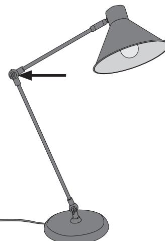
Die Schraube, die die Gelenke zusammenhält lösen, bevor die Gelenke eingestellt werden. Danach unbedingt wieder festziehen.
