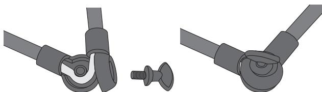
Das Gelenk der Leuchte muss zusammengeschraubt werden. Darauf achten, dass das Netzkabel nicht eingeklemmt wird.
