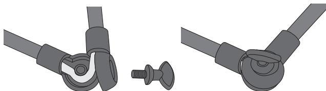
Valaisimen varsi tulee ruuvata yhteen niveliin kohdasta. Varmista, että virtajohto ei joudu puristuksiin.
